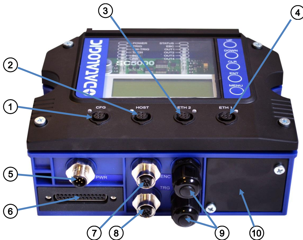
Abb. 35: Anschlussfeld eines SC5000 Controllers (Standardmodell)
