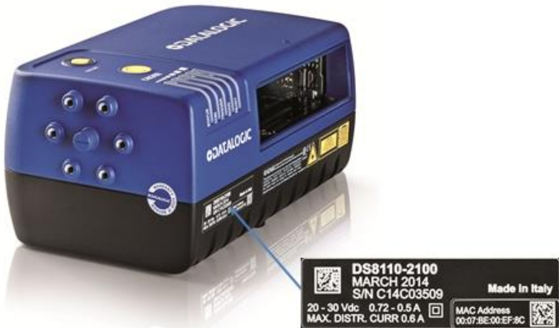
Abb. 61 – Ablesen des Scannermodells
