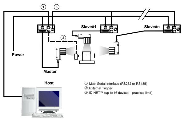
Figure 111 – ID-NET™ M/S Synchronized Layout
