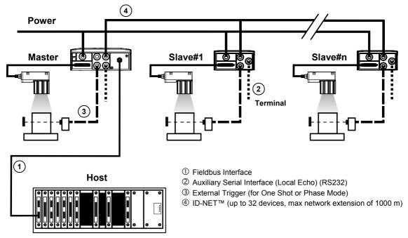
Figure 118 - ID-NET™ Fieldbus M/S Multidata
