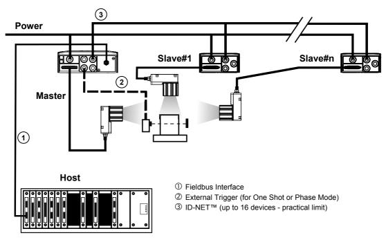
Figure 117 – ID-NET™ Fieldbus M/S Synchronized Layout
