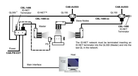
Figure 113 - ID-NET™ Synchronized Layout
