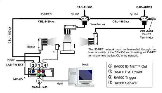
Figure 112 - ID-NET™ Synchronized Layout
