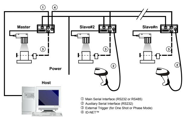
Figure 110 - Pass-Through On ID-NET™ Layout
