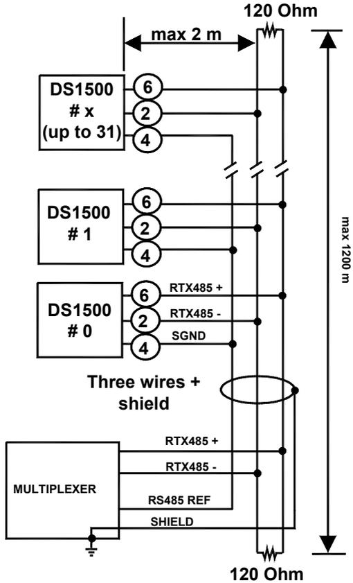
Figure 11 - DS1500 Multidrop Connection to a Multiplexer
